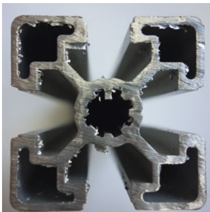
Werkstück vor dem Bürstvorgang
