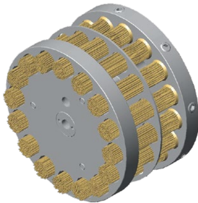
Schematische Darstellung eines Bürstkopfes für Entgratpinsel
