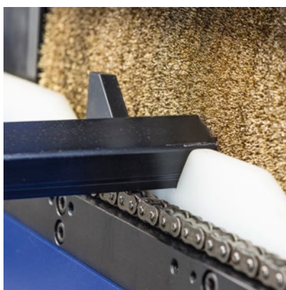
Funktionsschema eines Entgratautomaten mit Walzenbürsten
