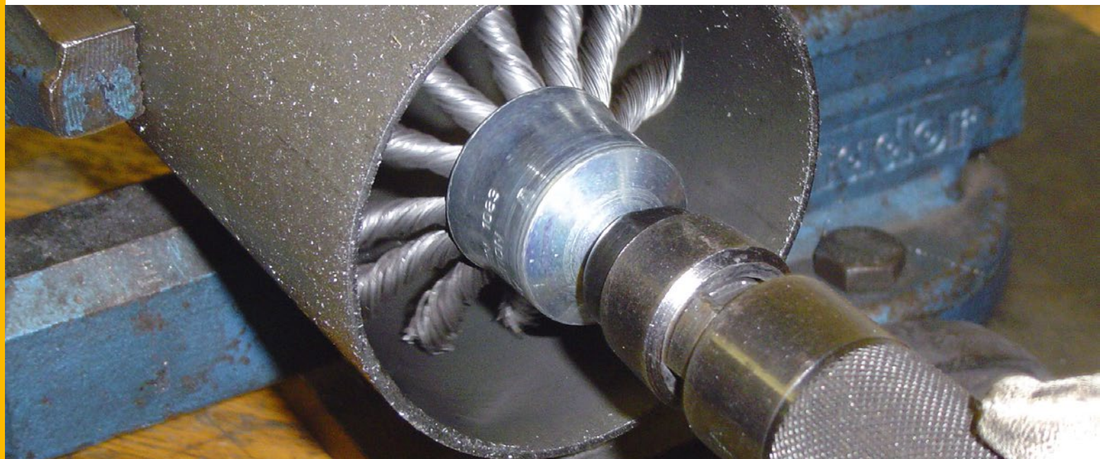
Öffnung der Pinseibürsten in Abhängigkeit von der Drehzahl
