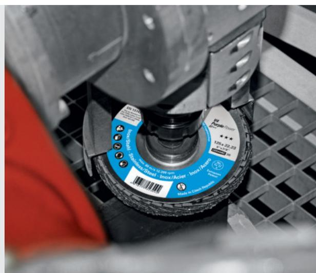
**Der für den industriellen Einsatz entwickelte Schleiflamellenteller „V4 Purple Power“ erreicht extreme Abtragsleistungen:**
