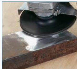
KLINGSPOR Schleiffiberscheiben sind hervorragend für grobe Schleifarbeiten, Entrosten von Metallteilen, Entgraten und die Bearbeitung von Schweißnähten geeignet. Auch für die Feinbearbeitung von Metallen finden diese Scheiben Verwendung.
