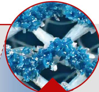
Die Anforderung nach einer sauberen Arbeitsumgebung, einer besseren Oberflächenqualität und reduzierten Verbrauchsmaterialkosten bedeutet, dass die Schleiflösungen weiterentwickelt wurden, vom papierunterlegten Schleifmittel zu einer Gitterkonstruktion.
