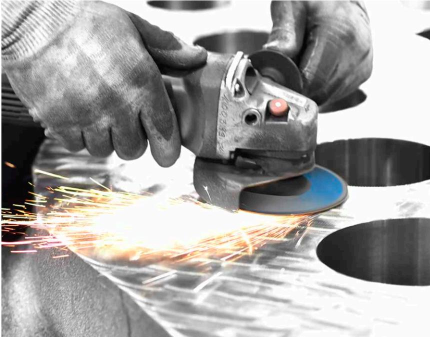
LUKAS-Schleiflamellenteller NAWAROFLEX® sind mit einem Träger aus nachwachsenden Rohstoffen ausgestattet. Diese speziellen Träger werden umweltbewusst aus Papier hergestellt und sind dennoch belastbar und bieten genug Stabilität für harte Schleifeinsätze.
