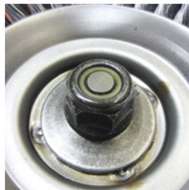
Richtiges Spannen der Bürste in die Motorsense
